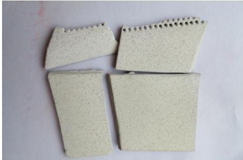
شکل ۳- قطعات پوشش داده شده با سد حرارتی
